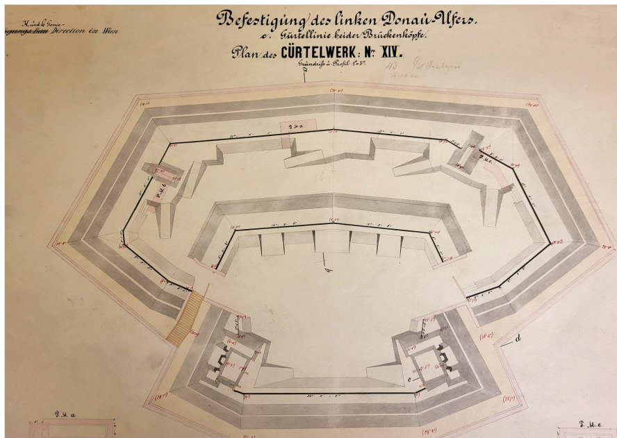
Befestigungsbauwerk links der Donau
